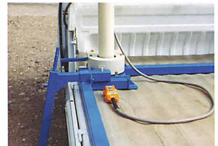
ハンドル旋回装置付なので、360°スムーズに旋回出来ます。
